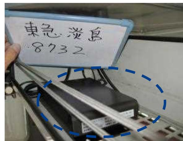
高精度測位技術対応車載機 (運転席上部に設置)
