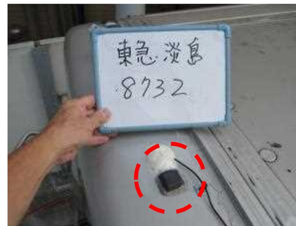
車載機アンテナ (前扉上部 : 既存アンテナ近傍)
