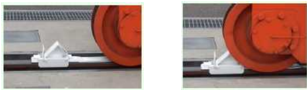
図 I - 5 クレーンストップパへの乗り上げと制動状況
