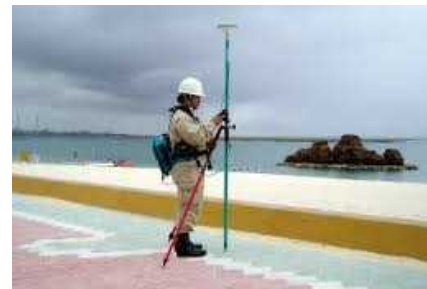
写真-3 観測局での測定の様子 ポールを計測点上に置き、ポール上のGPS受信機とスマートフォン端末をBluetoothで接続して操作する
