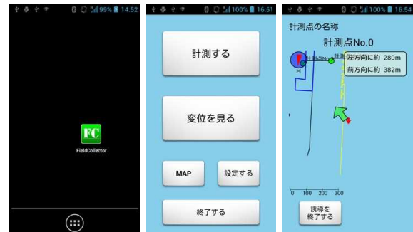
図-3 GPS受信機を操作するアプリケーション 左から、ホーム画面、起動時メニュー画面、計測時画面。cadファイル等を読み込むことで、平面図上で変位方向(右図中央部の矢印)を確認できる。
