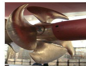
羽根の角度を変えることで推進効率を向上
