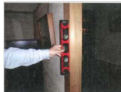
水平器による柱の傾きの計測
