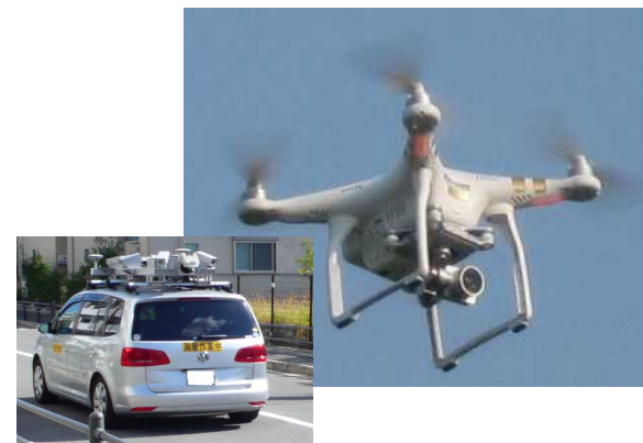
レーザ測量等に加え、 ドローンによる3次元測量も可能に
