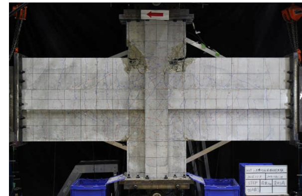
腰壁の損傷を伴う 柱崩壊型 (破壊形式C+W)
