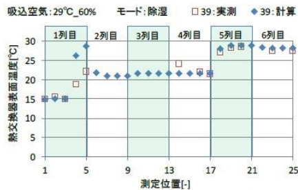
熱交換器表面温度比較 (29°C60%)
