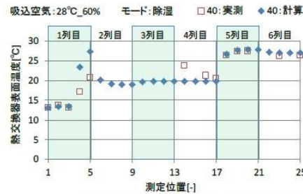
熱交換器表面温度比較 (28°C60%) 左:除湿、右:冷房
