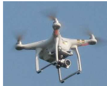
ドローン等による3次元測量
