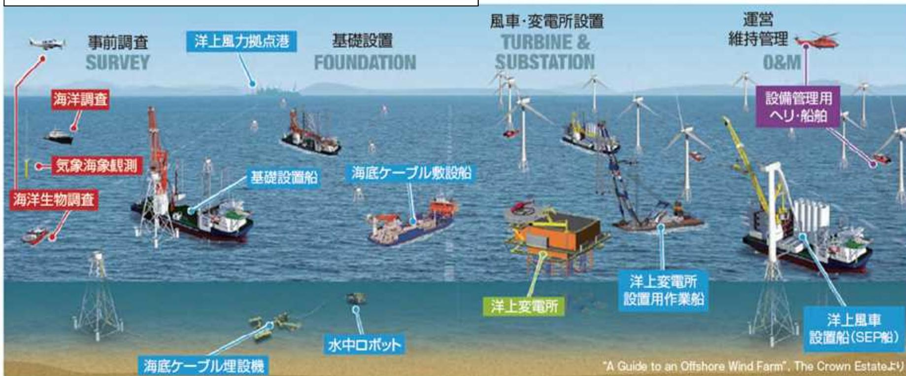
※SEP船 自己昇降式作業台船(Self Elevating Platform)
