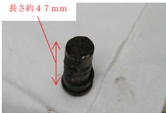
写真13 破断したピン(ピンA分離側)
