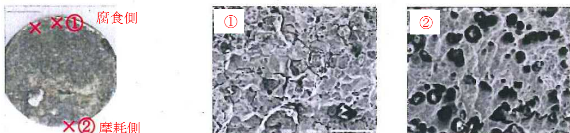
写真21 走査型電子顕微鏡による破面の状態
