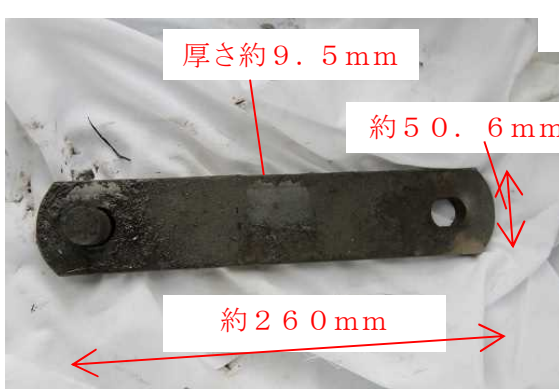
写真11 落下した外リンク板
