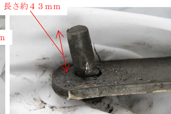
写真12 破断したピン(ピンA残存側)
