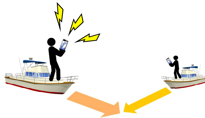
自船・他船の進行を予測して、衝突のおそれがある場合に警告する方法
