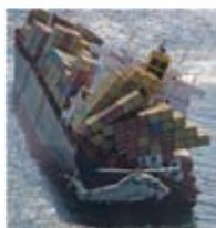
大型コンテナ船の荷崩れ事故
