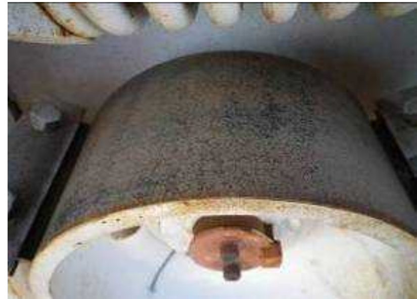
劣化度【c】走行装置、電動機内蔵ブレーキの状況(ドラム式)
