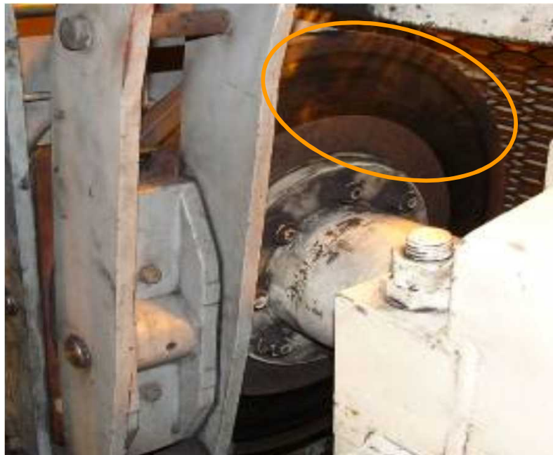
劣化度【a】ブレーキディスクの摩耗
