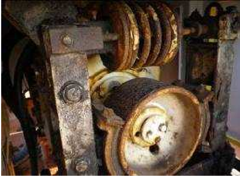
劣化度【a】走行装置、電動機内蔵ブレーキの状況(ドラム式)
