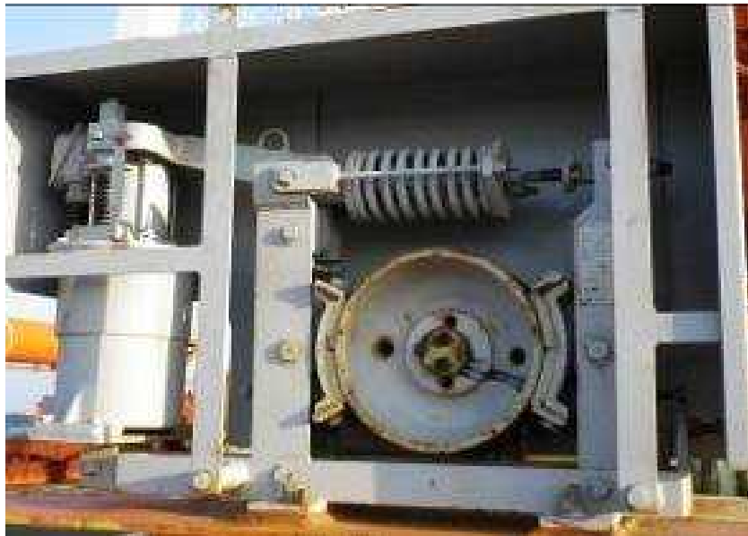
劣化度【c】走行装置、電動機内蔵ブレーキの状況(ドラム式)
