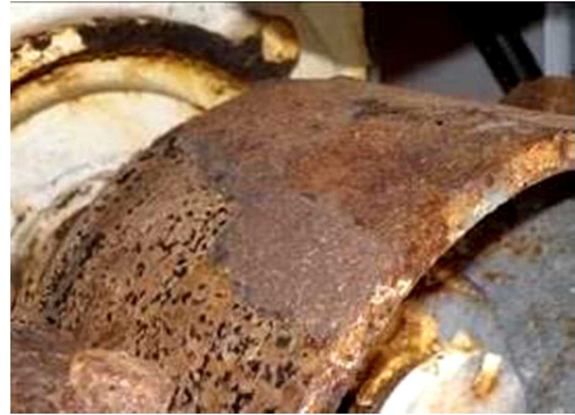
劣化度【a】走行装置、電動機内蔵ブレーキの状況(ドラム式)
