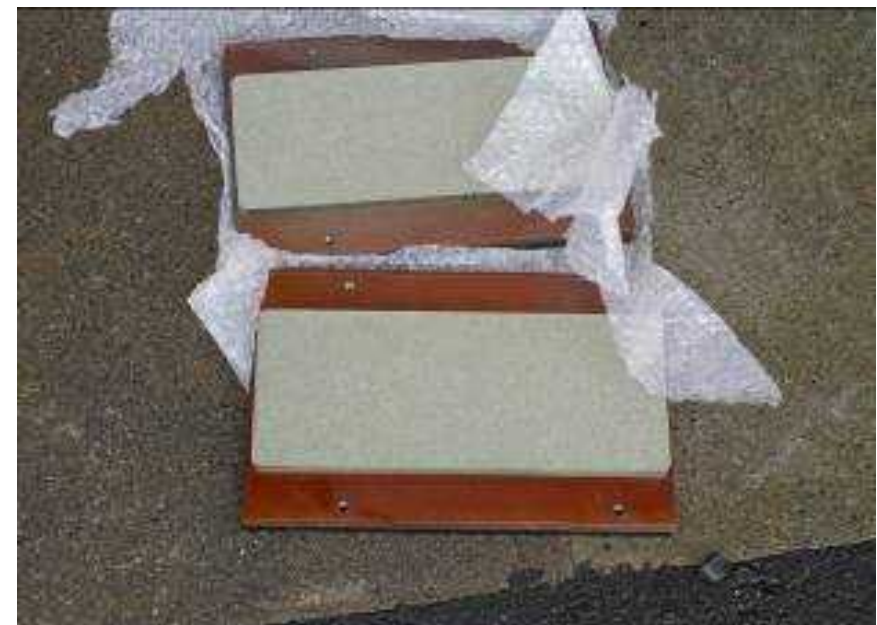
劣化度【d】レールブレーキ・パッドの状況
