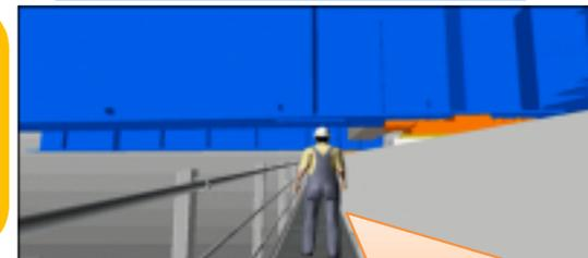
橋梁検査路の点検作業や点検動線を可視化し、設計品質を向上
