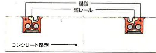
樹脂固定による制振軌道
