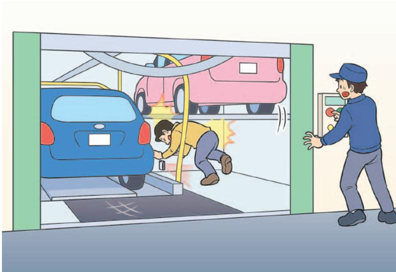
利用者が装置内に留まっていることに気づかずに、専任の取扱者が装置を稼働させたため、利用者が搬器に巻き込まれ死亡した。
