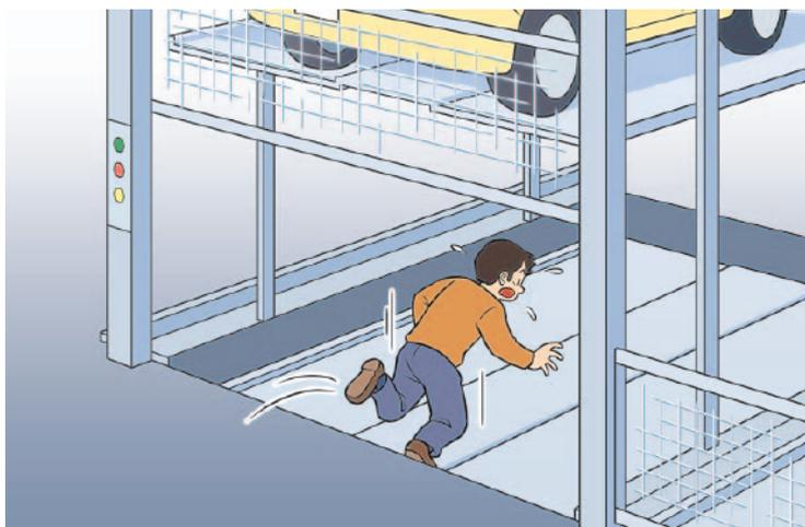
利用者が出庫のため前面ゲートを開いて装置内に入ったところ、搬器が着床しておらず、地下に転落し重傷を負った。
