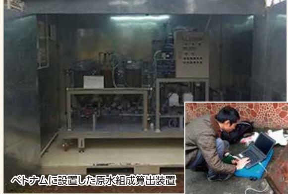
ベトナムに設置した原水組成算出装置
