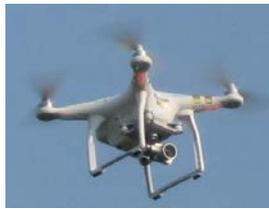
UAV(ドローン等)による3次元測量
