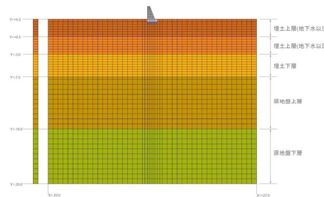
地盤や構造物などを有限要素ごとに分割し、電算機による解析にて、地震動による変形特性や液状化特性などの挙動を求める
