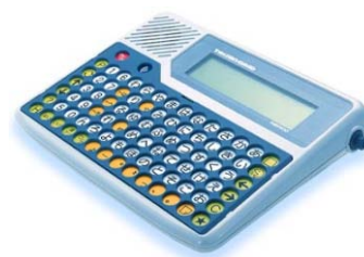
・入力した文章を音声で出力できる音訳の装置
