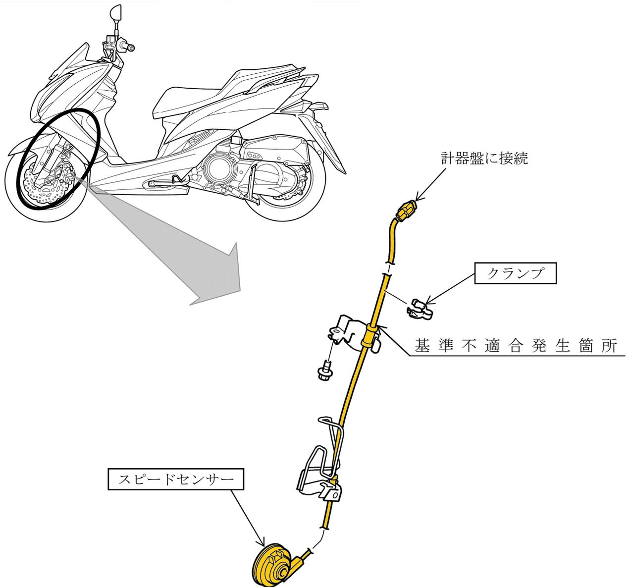
速度計において、車速センサーの電気配線をブレーキホースに固定するクランプの取付け方法が不適切なため、ハンドル操作を繰り返すとクランプが正規の取付け位置からずれることがある。そのため、車速センサーの電気配線の配索が変わり、そのままの状態で使用を続けると、当該電気配線が屈曲し、最悪の場合、断線して速度計が作動しなくなるおそれがある。
