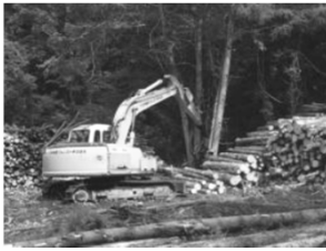
高性能林業機械による伐採作業
