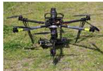
↑無人ヘリロボットによるコンクリート構造物のひび割れ検出技術
