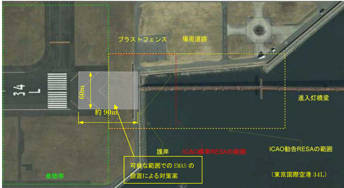
図 3.2.4 EMAS の設置による対策(案)の例
