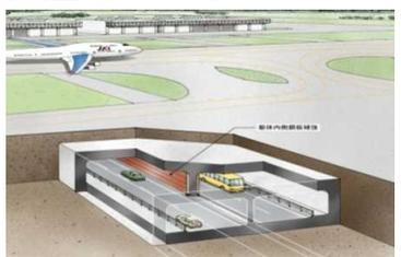
躯体の耐震補強により、地下構造物の損壊を防止
