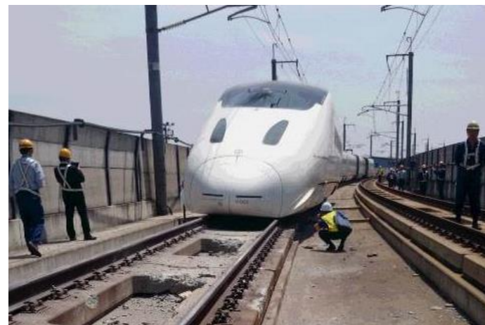
熊本駅～熊本車両基地間の脱線(4/16時点) 10
