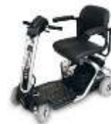
Megalite 4 全長：1,070mm 全幅：560mm 回転半径：2,130mm
