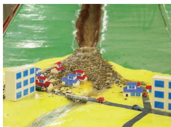
対策を何も施していない川。土砂が一気に流れ込み、家が…
