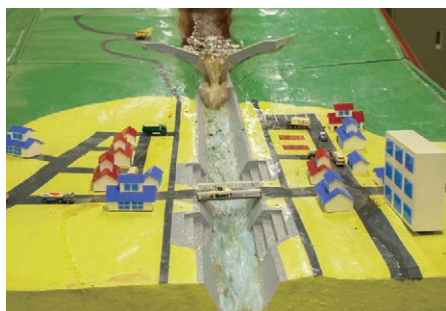
砂防えん堤を整備した川は、土砂がせき止められ安全！水だけが川を流れていく。
