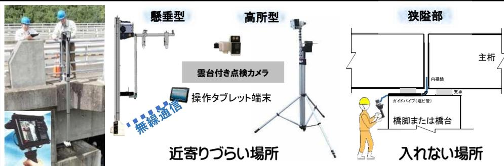
・橋梁点検ロボットカメラ等を用いて支承部、桁端部等の近接目視が困難な部位における損傷把握を容易にする技術である。
