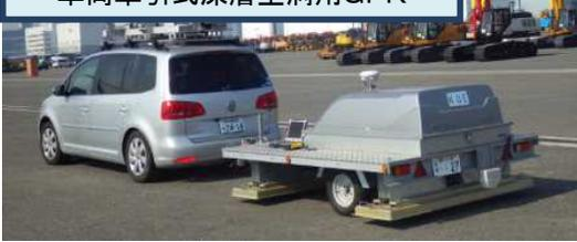
鉄筋対応型マルチチャンネルGPR
