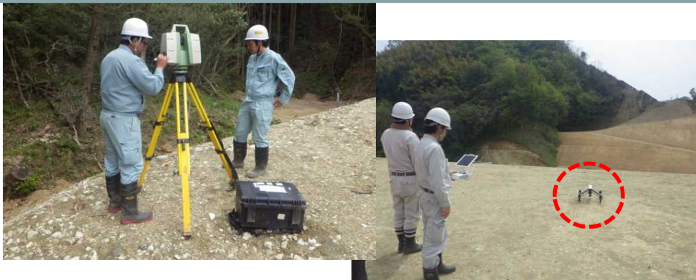
レーザースキャナー、UAVそれぞれの機器で精度確認を実施 両機器とも測定精度は同等。現場での実効性を確認
