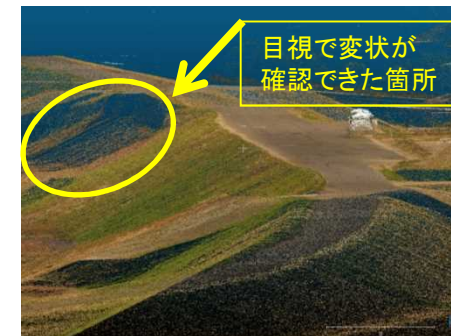
写真と測量成果を合成した 3Dデータによる現状把握
