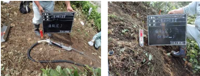
左上: 伸縮計 (変位センサ) 上: 地中傾斜計 (傾斜センサ) 左下: 亀裂変位計 (変位センサ)
