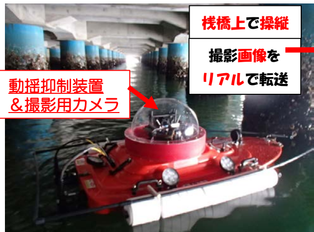
①ラジコンボートで栈橋下面の撮影
