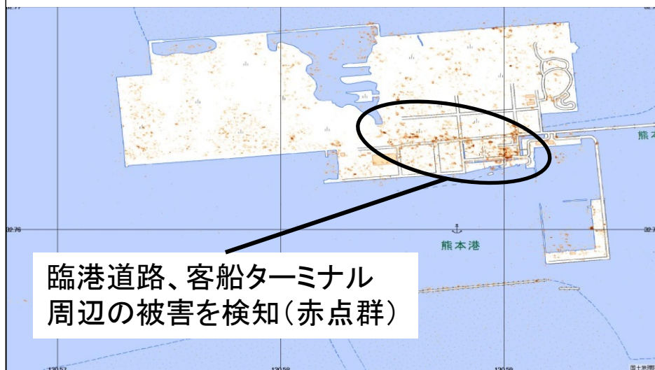
被災速報図(試作)による熊本港被害検知の結果
