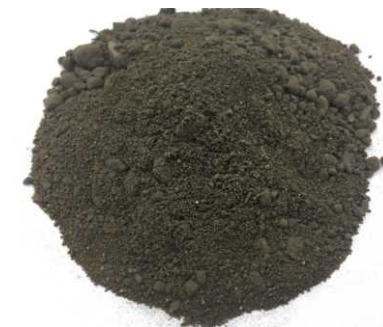
建設泥土改良土13
