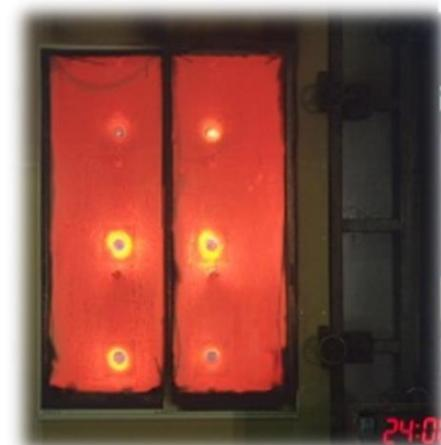
※アルミ窓では網入りガラス+Low-Eガラスの複層ガラスに比較し、耐熱結晶化ガラス+Low-Eガラスの複層ガラスは、貫通又は非加熱側への着炎までの時間が同等もしくは上回っている。
