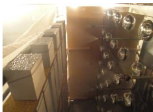
写真1 散水試験(促進試験)
