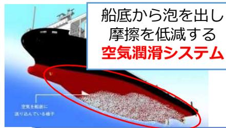
船底から泡を出し摩擦を低減する**空気潤滑システム**
