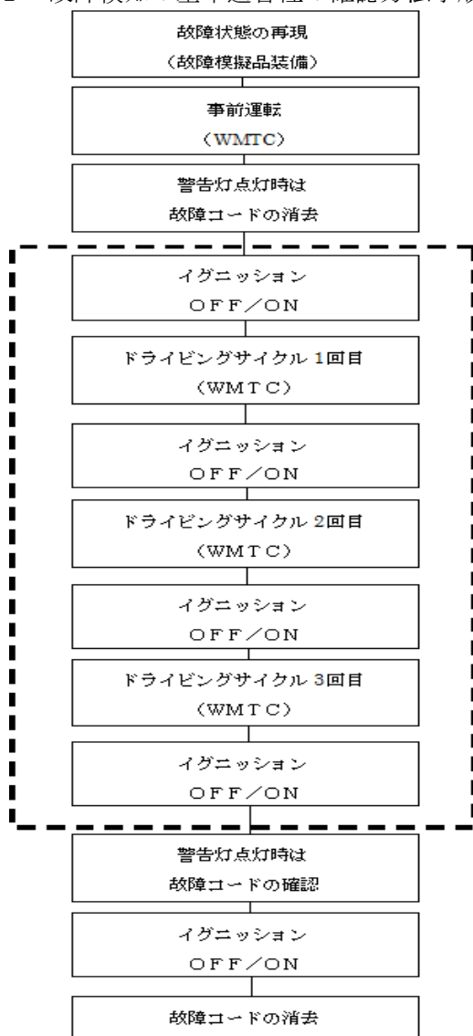
図1 故障検知の基準適合性の確認方法手順（例）
