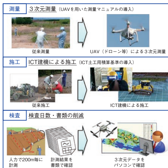
図表1-3-3 i-Constructionの推進（ICT土工の流れ）
