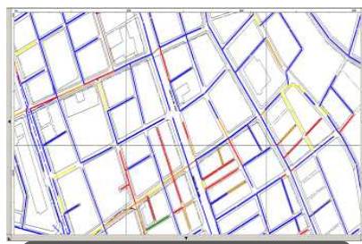
下水道管診断結果色分け図
