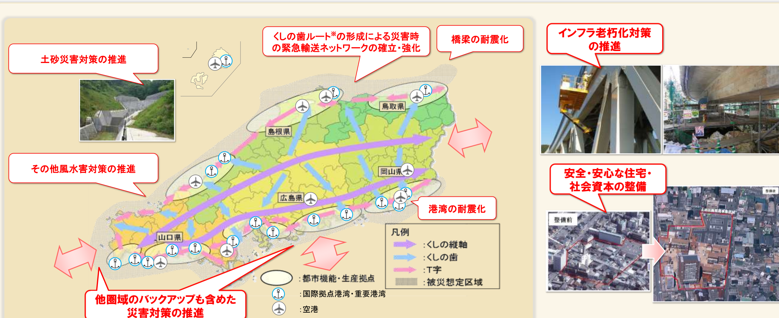
図 緊急輸送ネットワークのイメージ ※くしの歯ルート：道路啓開のルートをくしの軸と歯に見立てたもの
