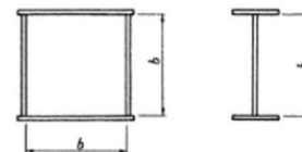
図-4.2.1 板の固定縁間距離
