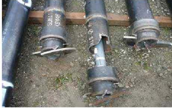
写真-1 先端部及び鋼管ケーシング(開発時)
