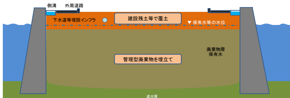
図-1 厚覆土工法の基本概念
