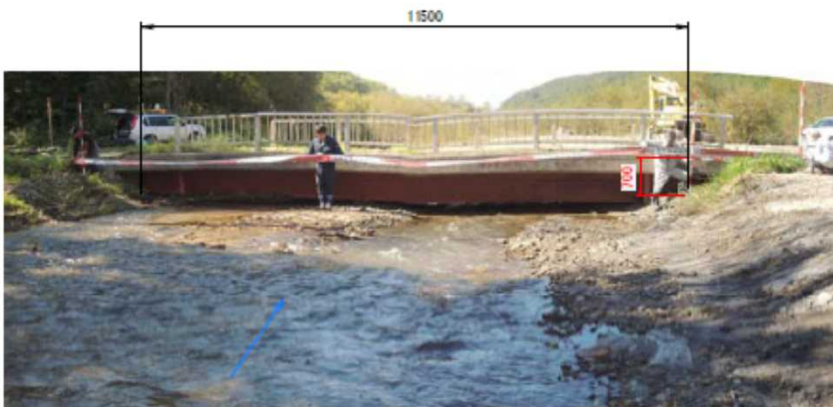
河道の横断測量の例
