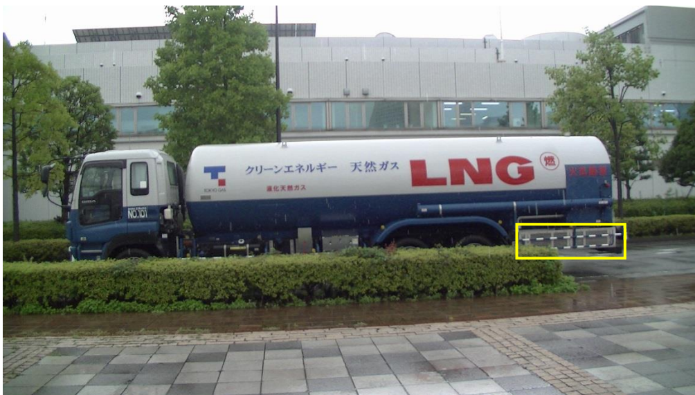
図 3.5 東京ガス㈱の LNG ローリーの気化器（黄枠内が気化器）
