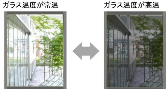
温度によって光学特性が変化するフィルムを用いたガラス（イメージ図）
