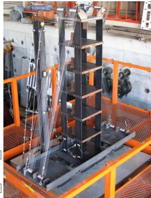
平成25年 縮小試験体を用いた振動台実験 8
