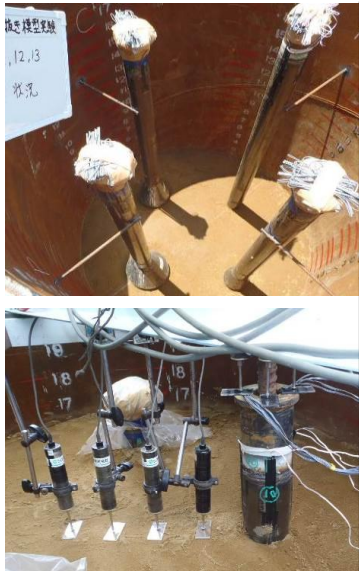
① 拡底杭(模型杭)の土層実験
