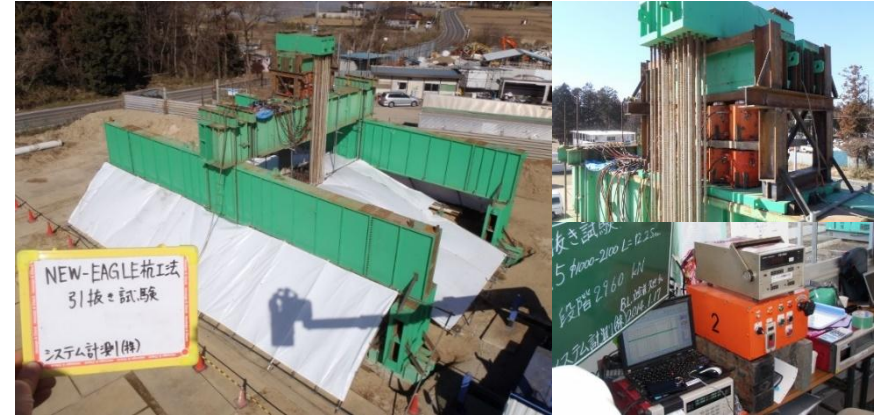
② 引抜き試験状況
