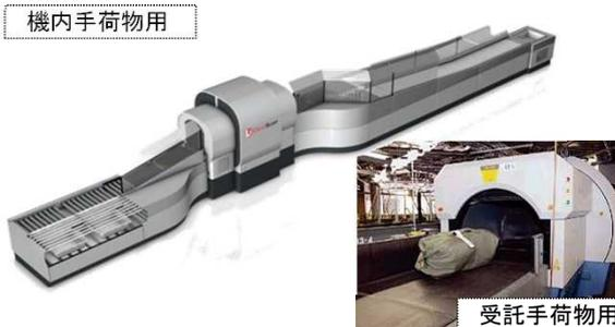
機内持込・受託手荷物のX線検査機器のうち、爆発物を自動的に検知するシステム
